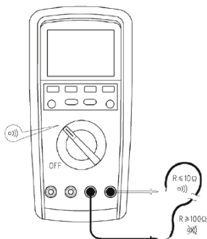
Рис. 5 Проверка целостности цепи
